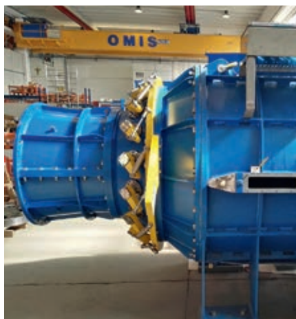
Réception en atelier de la turbine du Pont-de-la-Tine, 265 kW, Suisse
