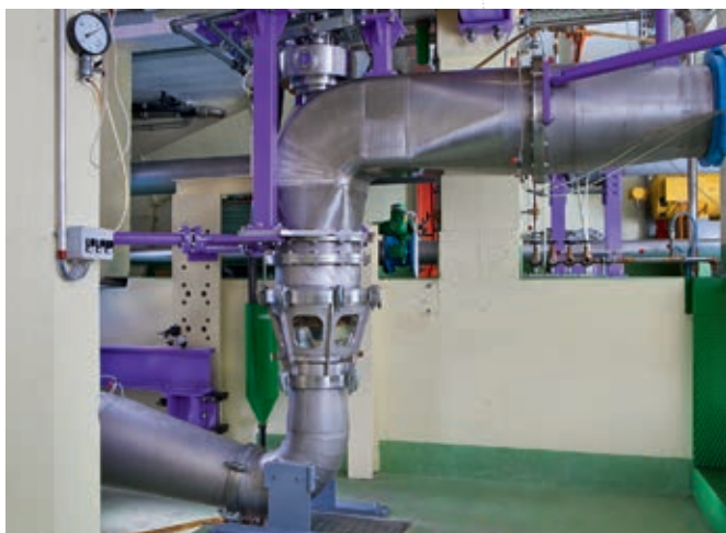
Modèle de laboratoire d'une turbine Saxo
